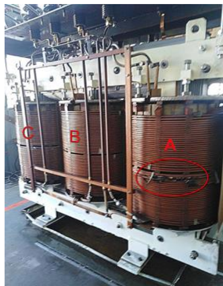
Слика 5. Налаз приликом отварања и прегледа ЕТ у сервисној радионици
