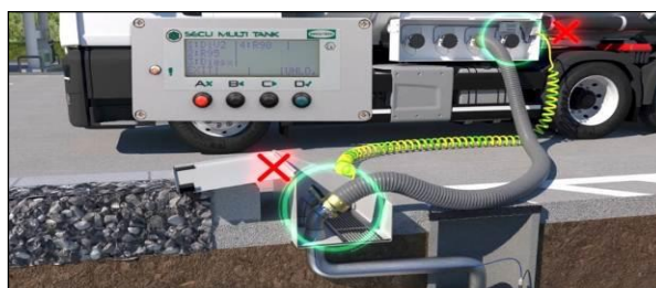
Slika 17 - Prikaz blokade istakanja goriva Fig. 17 - Review of blocked unloading
