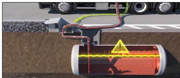
Slika 21 - Prikaz prepunjavanja rezervoara gorivom Fig. 21 - Review of overfilled petrol station tank
