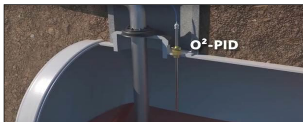
Slika 14 - Prikaz postavljenog sistema O 2 PID Fig. 14 - Review of installed O 2 PID system
