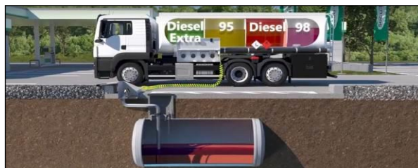
Slika 13 - Prikaz uspostavljenog uzemljenja Fig. 13 - Review of installed earthing cable
