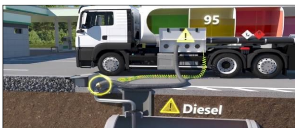
Slika 19 - Prikaz pogrešno povezane instalacije Fig. 19 - Review of inadequate connected instalation
