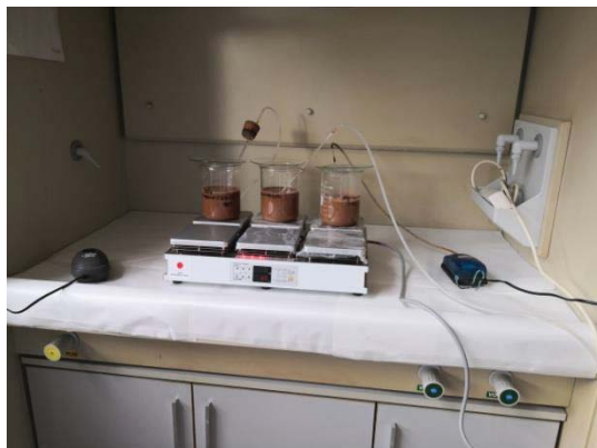
Slika 2 - Luženje jarozita na magnetnoj mešalici Figure 2 - Leaching of jarosite on a magnetic stirrer
